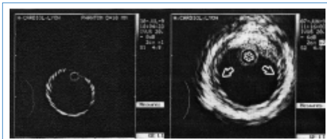
Fig. 2 : La réponse impulsionnelle latérale. Elle produit sur l'image échographique un aspect lamellaire d'une interface circulaire sur un fantôme en plexiglas (A) ou sur une artère iliaque pathologique (flèche en B) lorsque le transducteur (étoile en B) est excentré.
