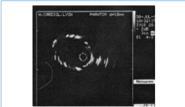
Fig. 1 : Déformation caractéristique en ellipse quand le transducteur est décentré et angulé.
